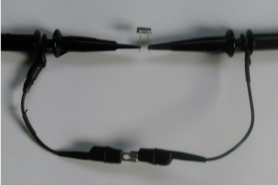
測定前に、ノーマライズを行うと、A と B チャンネルの誤差が解消され、より精度が高くなります。
