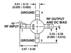
IC7は、左図のように先のとがった部分が1番ピンです。 基板上では1番ピンに、1と印刷されています。
