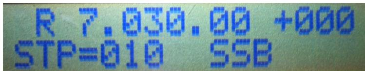
組立てが完了して時点で、操作スイッチなどは接続せず、この表示なることを確認してください。
