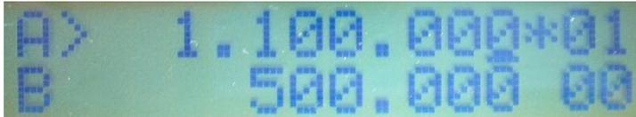
メモリーライトによって、メモリーに書き込まれると、チャンネル番号の左側に※マークが入ります。再度、書込み操作を行うと、クリアされます。メモリーには、基準点、オフセット、倍率、発振方向なども一緒に記憶されます。
